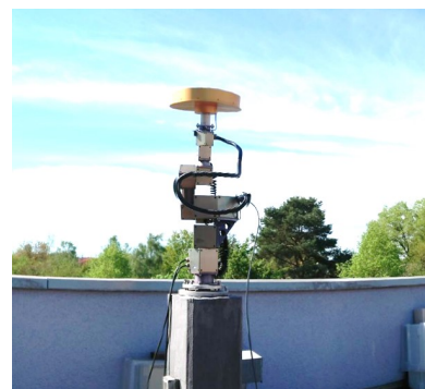
Figura 6.14: Brazo robótico para la calibración absoluta de antenas GNSS , http://www.geopp.de
