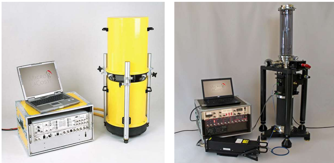
Figura 3.10: Gravímetro FG-5 (panel izquierdo) e gravímetro A-10 (panel derecho), cortesía de ( www.microglacoste.com ).
