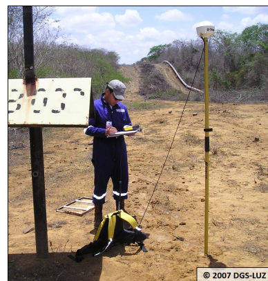
Figura 5.5: Escenarios típicos de la observación GNSS en modo estático-rápido
