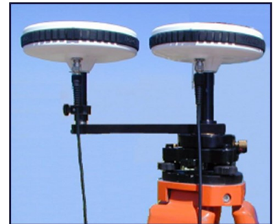
Figura 5.6: Disposición de antenas GPS para un antenna swap , algunos receptores incluían los accesorios para facilitar el proceso, imagen: 1999 Magellan Corporation
