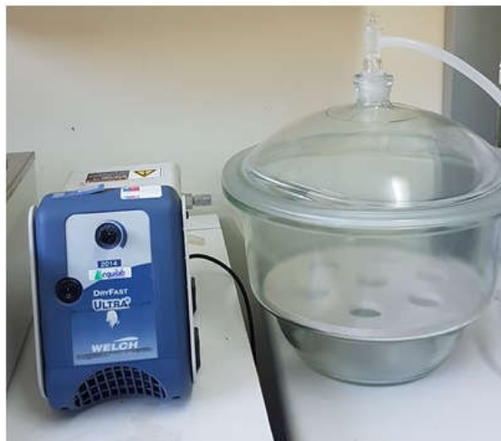
Figura. 1. Campana desecadora acoplada a bomba de vacío. Las muestras se colocan en su fijador dentro de la cámara y se dejan hasta 15 min o más. Un indicador de que el aire se ha retirado es cuando las muestras bajan al fondo del recipiente con el fijador.
